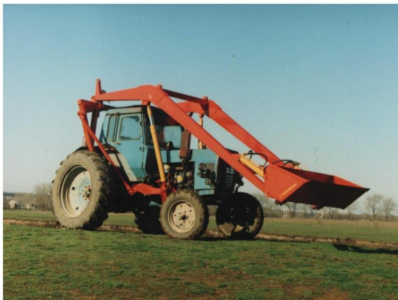
**Рис.1а Стогометатель-погрузчик с ковшом в агрегате с трактором МТЗ**
