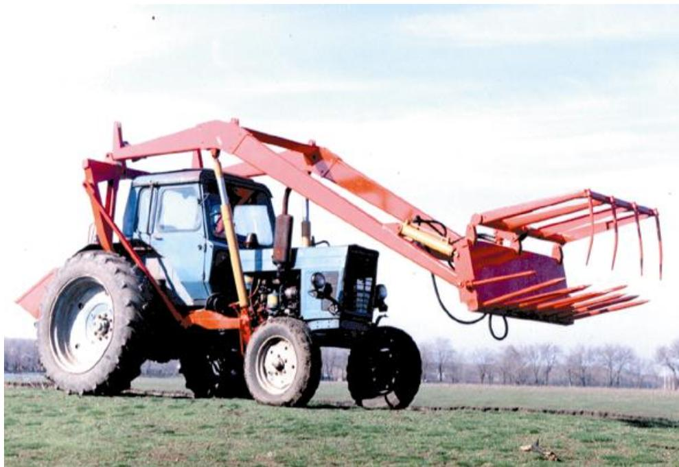
**Рис.1с Стогометатель-погрузчик с вилами в агрегате с трактором МТЗ**
