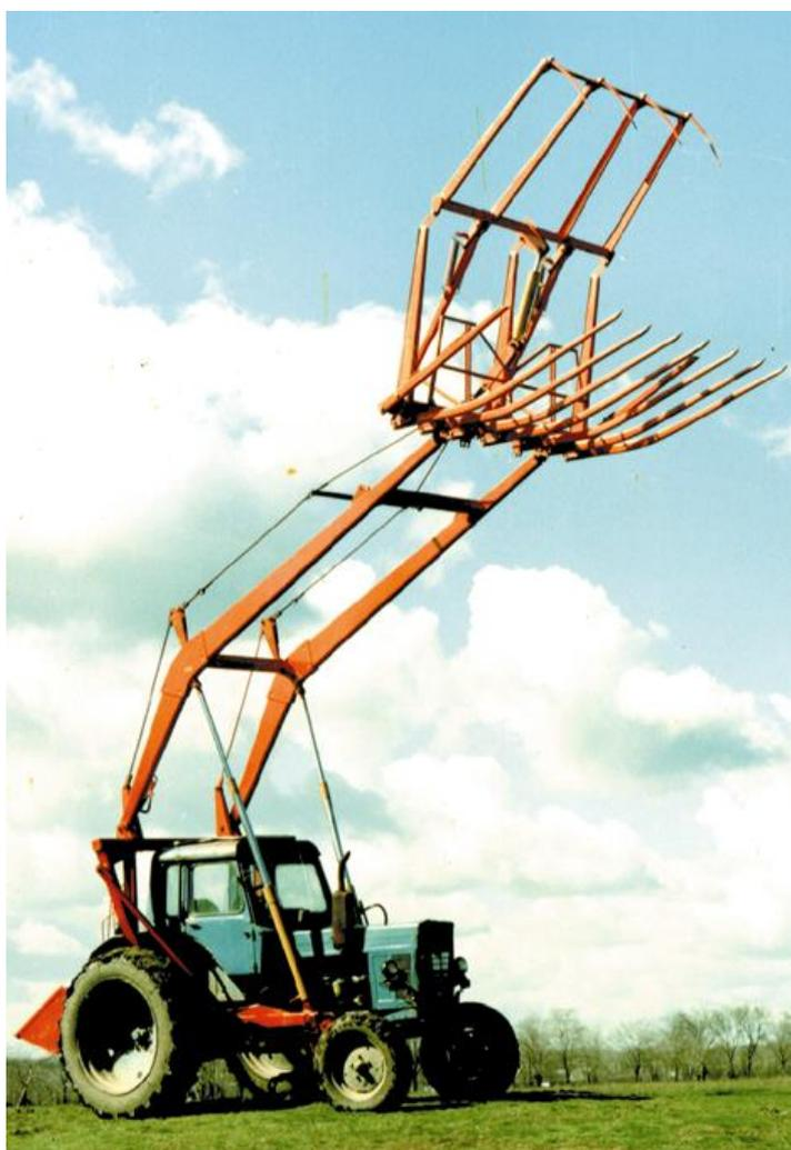
**Рис.1б Стогометатель-погрузчик с платформой в агрегате с трактором МТЗ**
